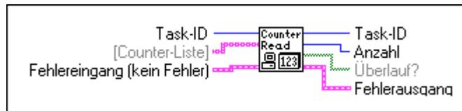
Das VI ist so ausgelegt, daß es einen Counter oder zwei verknüpfte Counter eines Am9513-Counter-Chips oder einen Counter eines DAQ-STC-Counter-Chips liest.
