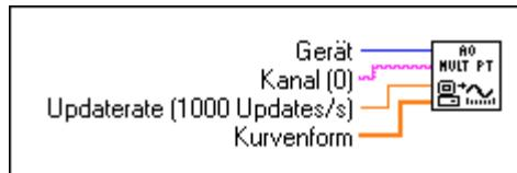
Das VI AO Signalverlauf erzeugt auf einem angegebenen Analogausgangskanal eine Mehrpunkt-Kurvenform. Bei Auftreten eines Fehlers wird ein Dialogfeld angezeigt, wodurch Sie die Möglichkeit haben, das VI zu stoppen oder fortzusetzen.
