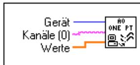
Das VI AO Ausgangskanäle aktualisiert Mehrfach-Analogausgangskanäle mit Einzelwerten.
