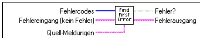
Wenn dieses VI einen Fehler findet, setzt es die Parameter in dem Fehlerausgangscluster. Sie können diesen Cluster mit dem Einfacher oder Allgemeiner Error-Handler verbinden, um Fehler zu identifizieren und für den Benutzer zu beschreiben.
