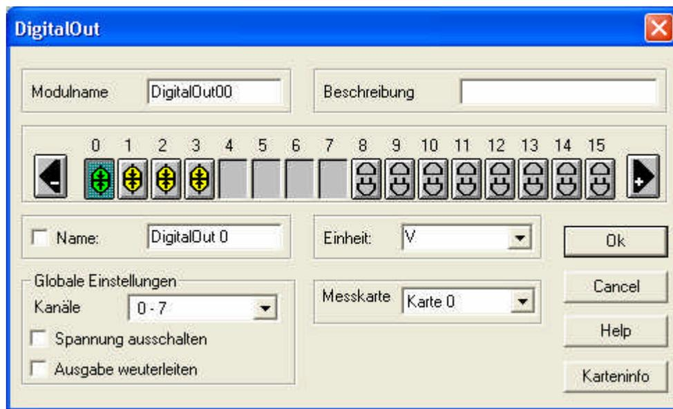
Auf den USB-Basic Messkarten werden die digitalen Signale asynchron ausgegeben. Die digitalen Kanäle lassen sich in 4(8) Bit Gruppen für die Ein- oder Ausgabe programmieren. Demnach werden die einzelnen Kanalgruppen in dem Auswahlfeld Kanäle ausgewählt.
