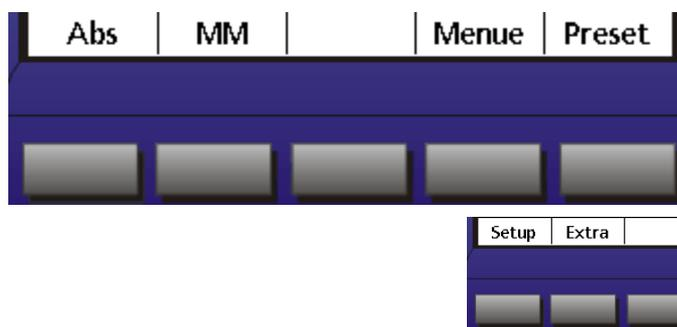
**Preset** wechselt in den Modus zur Eingabe eines Presetwertes für die gewählte Achse.
