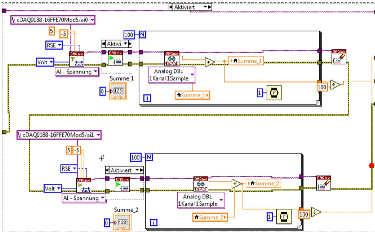
Messung der Spannungen mit den DAQ Modulen.
