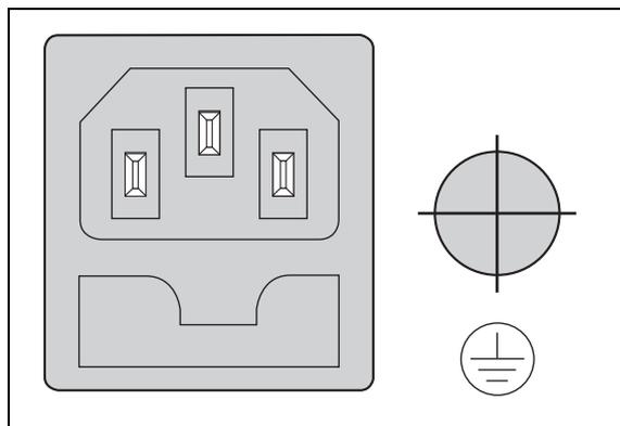
Abb. II.4 Netz- und Erdungsanschluss auf der Gehäuse-Rückseite
