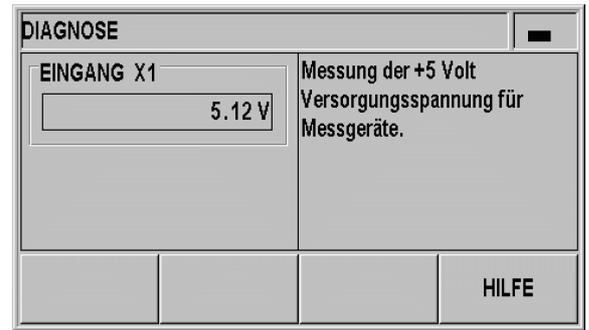
Abb. II.43 Versorgungsspannung
