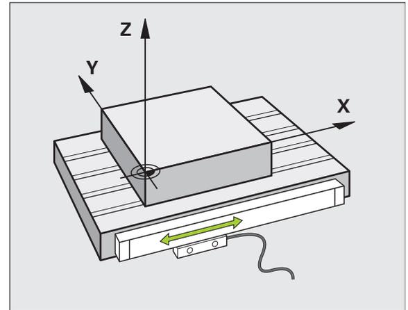
Abb. I.7 Positionsmessgerät für eine Linearachse, z. B. für die X-Achse
