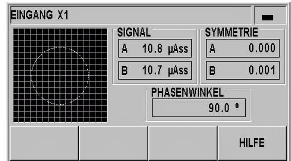
Abb. II.39 Messgeräte-Test: 11  $\mu$ Ass-Schnittstelle
