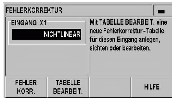
Abb. II.22 Eingabemaske für die nichtlineare Fehlerkorrektur
