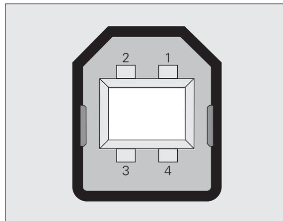
Abb. II.46 USB Typ B Buchse (UART)
