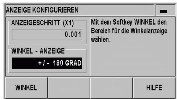
Abb. II.17 Eingabemaske ANZEIGE KONFIGURIEREN für ein Winkelmessgerät
