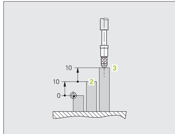
Abb. I.6 Position **3** zum Beispiel „inkrementale Werkstück-Positionen“
