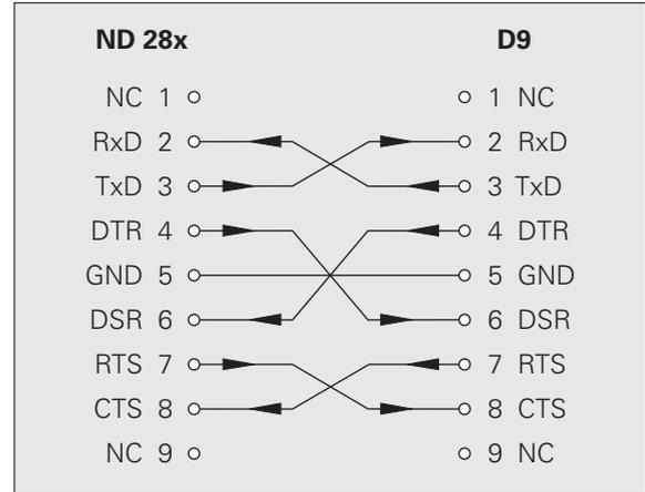
Abb. II.48 Pin-Belegung des seriellen Anschlusses mit Handshake
