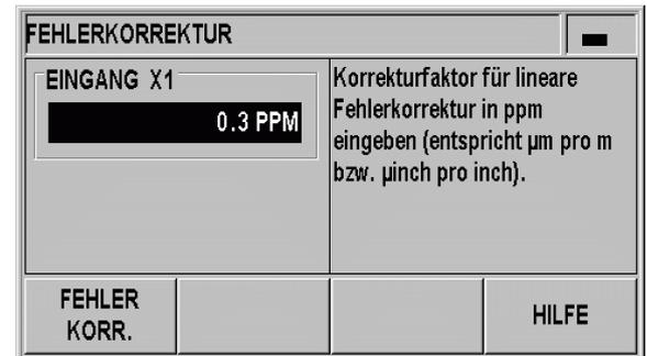
Abb. II.21 Eingabemaske für die lineare Fehlerkorrektur
