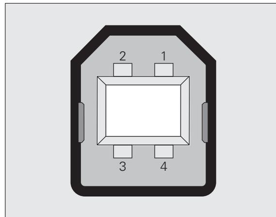
Abb. II.50 Pin-Belegung USB Typ B Buchse
