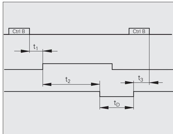
Abb. II.52 Signallaufzeiten bei Messwert-Ausgabe nach Befehl Control B
