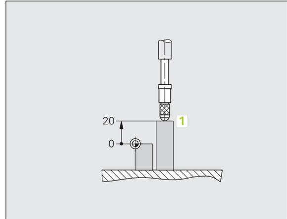
Abb. I.5 Position **1** zum Beispiel „Absolute Werkstück-Positionen“
