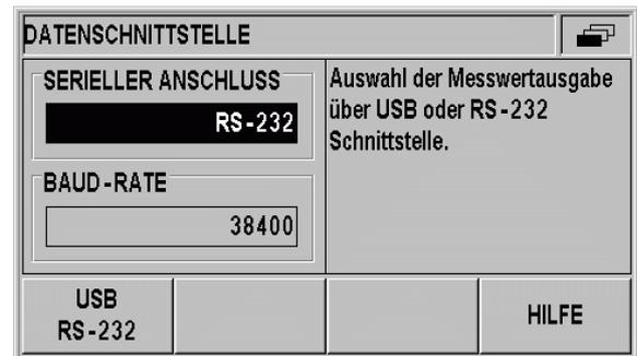
Abb. II.32 Datenschnittstelle V.24/RS-232-C
