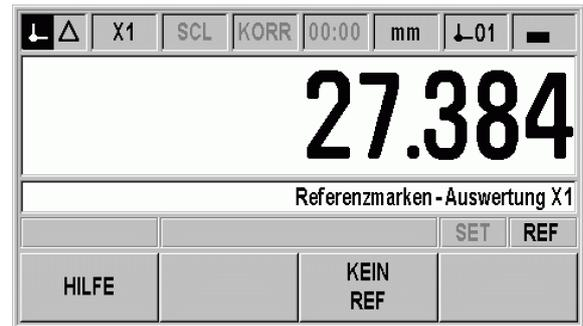
Abb. I.12 Anzeige bei der Ermittlung der Referenzmarken
