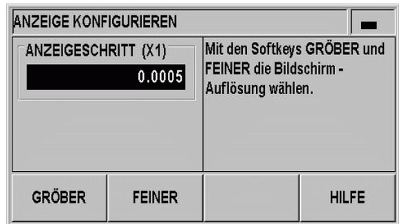
Abb. II.16 Eingabemaske ANZEIGE KONFIGURIEREN für ein Längenmessgerät
