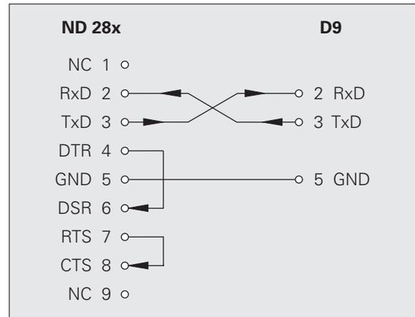
Abb. II.49 Pin-Belegung des seriellen Anschlusses ohne Handshake
