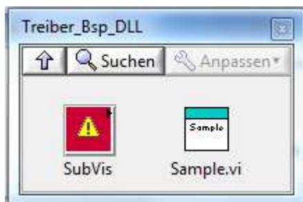
Ansicht des Unterordners SubVis welches von LV automatisch generiert wurde, LV zeigt alle Vis aus einer DLL selbst an. Um eine andere Ansicht zu erhalten, als LV vorschlägt, entfernen wir jetzt das Sample.vi in der Ansicht nicht in der DLL. Das Sample.vi haben wir zuvor mit der Palettenbearbeitung nach vorne gebracht, so dass es im Unterordner Subis nicht mehr benötigt wird.
