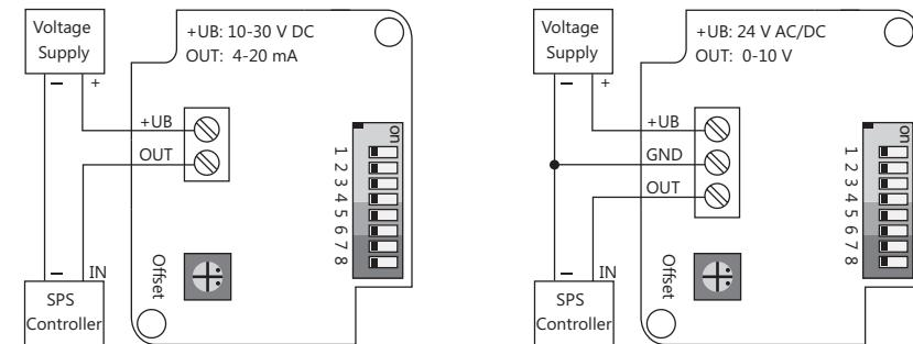
Achtung: Bei Parallelbetrieb mit 24 V AC Versorgung, ist der phasengleiche Anschluss aller Geräte zwingend notwendig (Kurzschlussgefahr)!
