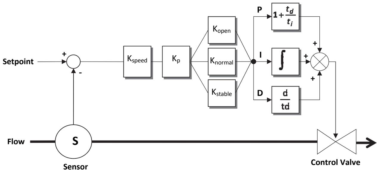
Wenn ein schnelleres oder langsames Ansprechverhalten des Reglers erforderlich ist, muss im Grunde nur controller speed ( $K_{\text{speed}}$ ) oder PID- $K_p$  geändert werden.
