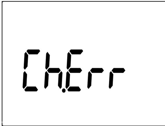
**Abbildung 6-3** Ladeanschluss-Alarm
