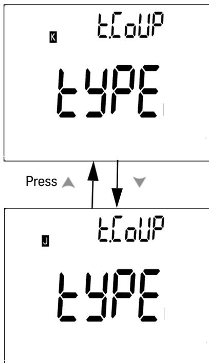
**Abbildung 4-3** Einrichtung des Thermoelementtyps
