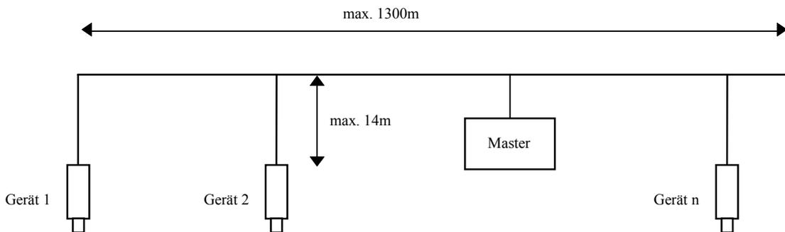
Folgender RS485 Treiber wird in den LEO\_RECORD-Geräten eingesetzt: MAX3471
